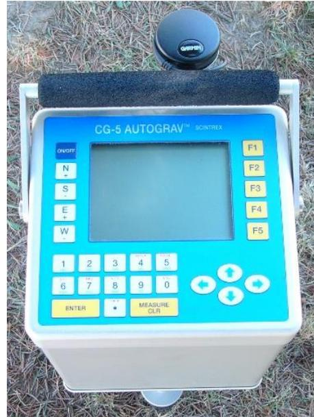
Fig. 5-11 CG-5 Autograv gravimeter
