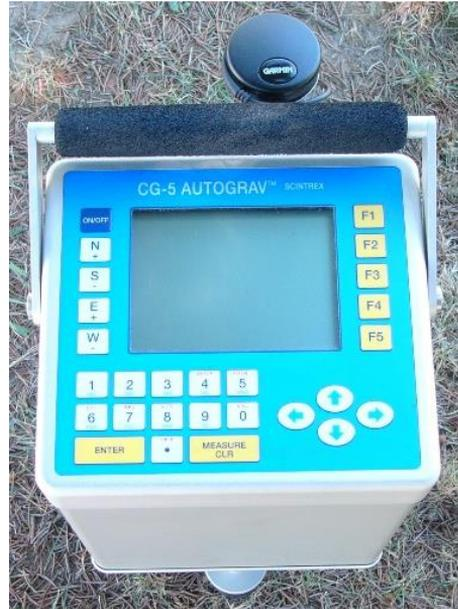
Fig. 5-11 CG-5 Autograv gravimeter
